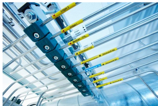
Abbildung 5: Fraunhofer IPM verfügt über Gasmessplätze zur Kalibrierung und Charakterisierung von Gasmesssystemen, Bildquelle: © Wudtke/Fraunhofer IPM
