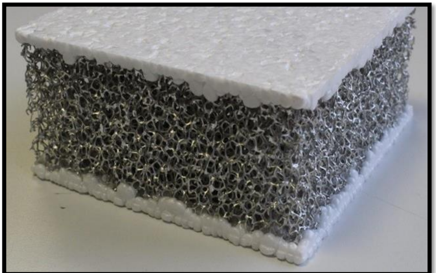
Abbildung 2: teilgefüllter Al-EPShybridschaum, Bildquelle: Karlsruher Institut für Technologie
