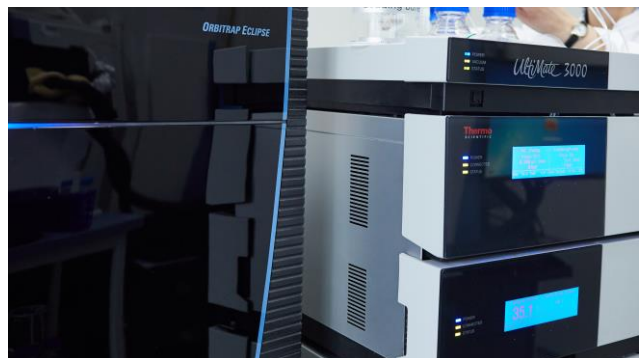
Abbildung 4: Hochauflösendes Massenspektrometer für die Untersuchung der Bindung von Antikörpern an Oberflächenproteine des Coronavirus SARS-CoV-2, Bildquelle: NMI
