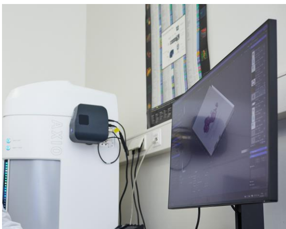
Abbildung 5: NMI-Wissenschaftler untersuchen mit einem Slide-Scanner-System (AxioScan.Z1, Fa. Carl Zeiss) die Infektion und Vermehrung von SARS-CoV-2-Viren in Gewebeschnitten und zellulären Modellsystemen (z.B. Organoiden), Bildquelle: NMI
