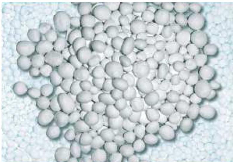
Abbildung 20: Endprodukt des NuReSys-Verfahrens
