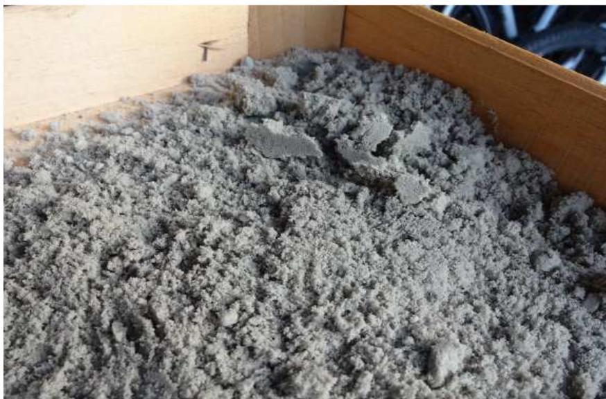
**Abbildung 24: MAP-Produkt nach dem Stuttgarter Verfahren auf der KA Offenburg**
