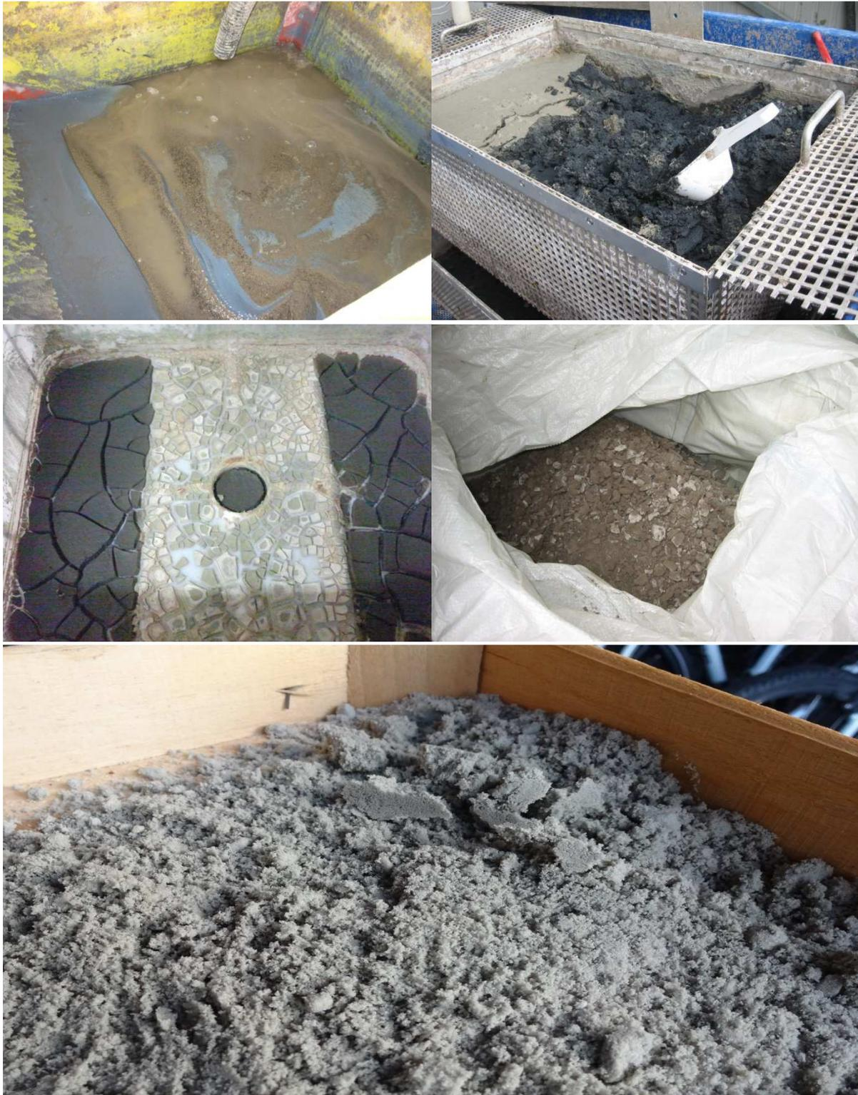
**Abbildung 27: MAP-Produkt auf der KA Offenburg mit unterschiedlichen Trocknungsgraden**
