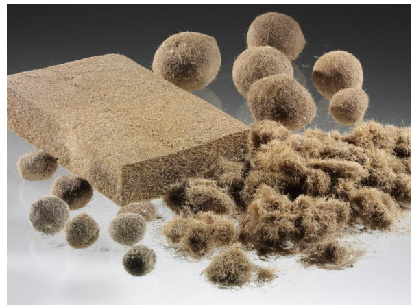
Faseragglomerate, geschnittene Fasern und Dämmmatte © Fraunhofer ICT
