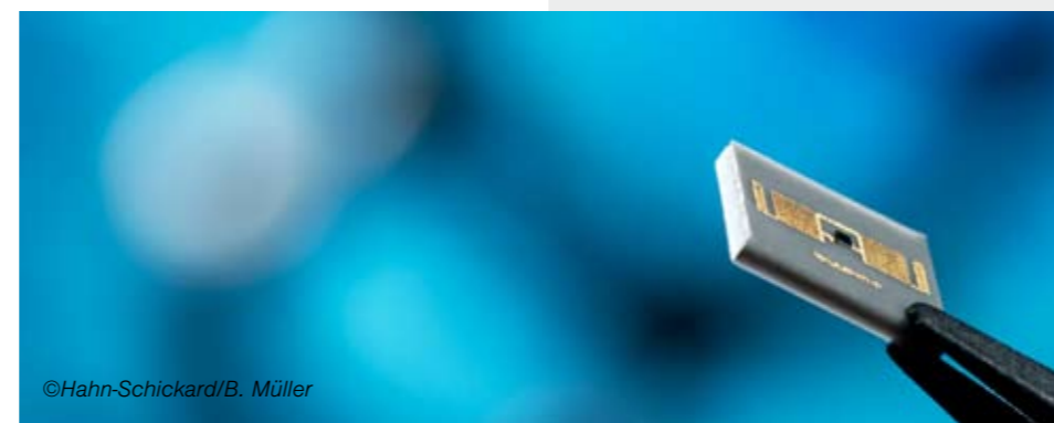
Transponderchip zur zuverlässigen Erkennung und Nachverfolgung von chirurgischen Instrumenten (Beispielprojekt)
